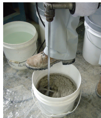
電動ドリルでの練混ぜ
