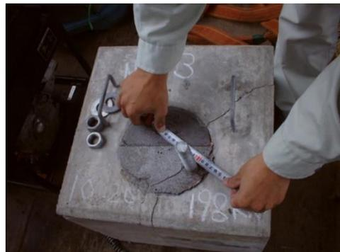
引抜き試験 105kN(O.K)
